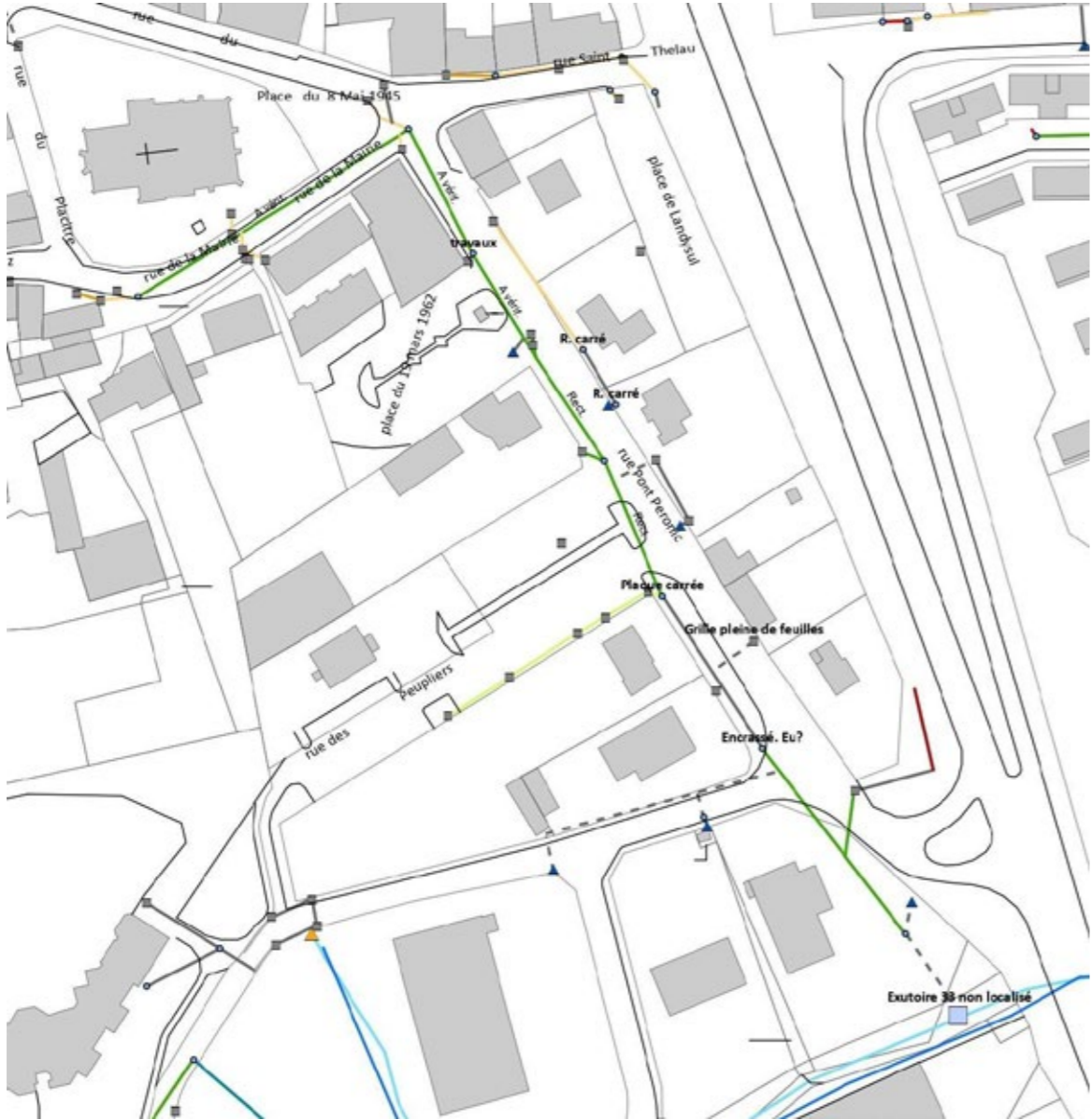
Plan des réseaux de collecte des eaux pluviales existants approuvé le 29 juin 2017 (source: annexe sanitaire PLU-DCI Environnement)
