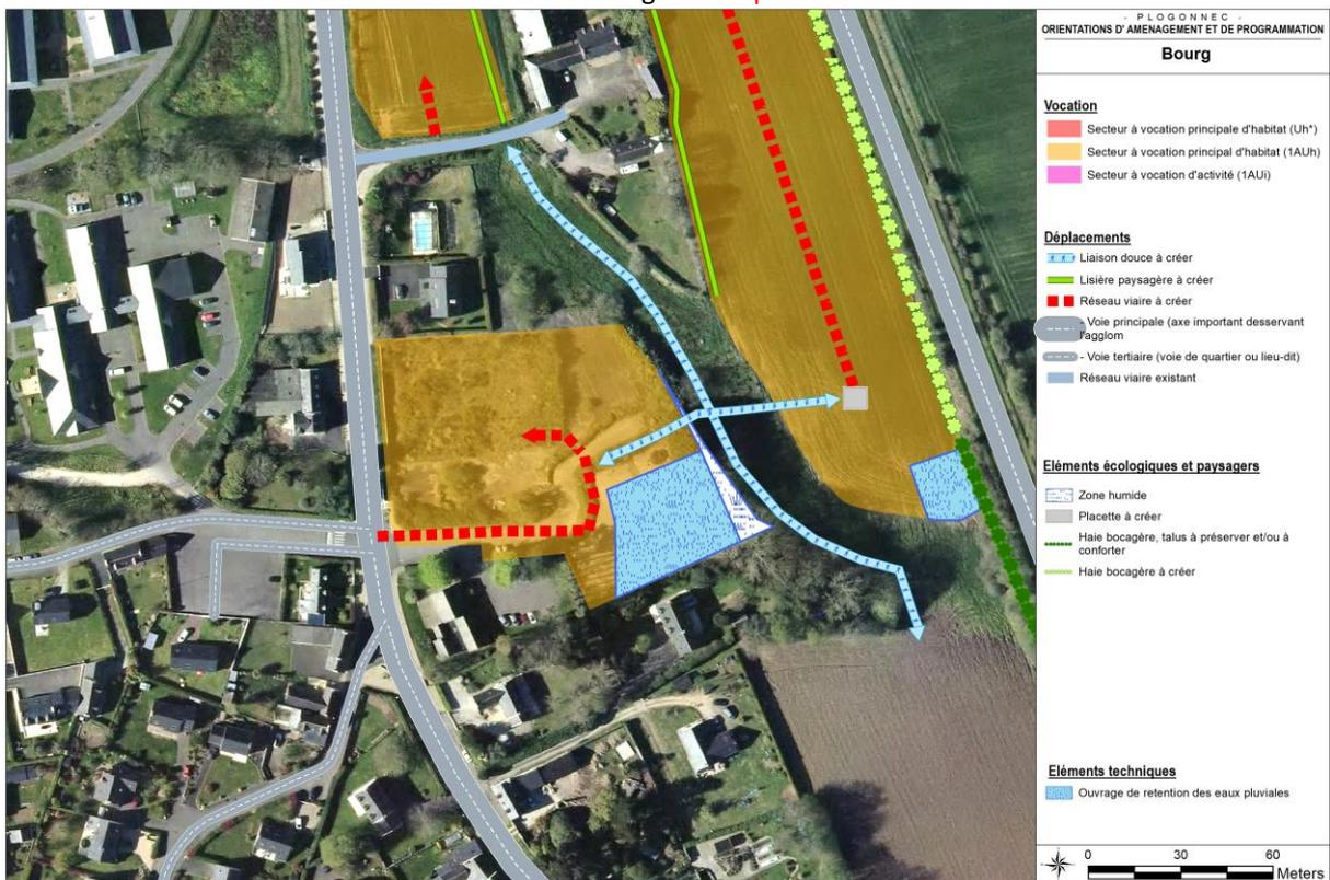
⇒ L'ouvrage de rétention des eaux pluviales est diminué pour tenir compte de la zone humide identifiée sur l'emprise de la zone 1AUh de « Kerinou 1 ».
